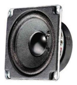
5 cm (2") Breitbandlautsprecher mit quadratischem Korb, weicher Sicke und leichter Spezialmembran. Ausgeglichener Frequenzgang ab 250 Hz und spritzige Hochtonwiedergabe mit gutem Rundstrahlverhalten. Geeignet als Mitteltöner in Lautsprecherzeilen für HiFi- und Beschallungsanlagen sowie für ELA-Systeme in 100-V-Technik. Durch die geringen Abmessungen auch sehr gut für den Modellbau und als Kontrolllautsprecher in elektronischen Geräten geeignet.
